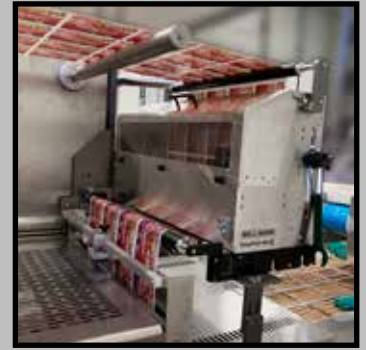
MLP X auf einer HFFS-Lebensmittelverpackungslinie
