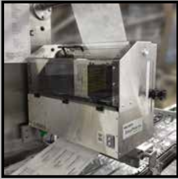
MLP auf einer HFFS-Verpackungslinie für medizinische Geräte
